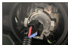
Ligue as conexões do LED OEM no conector do veículo.
